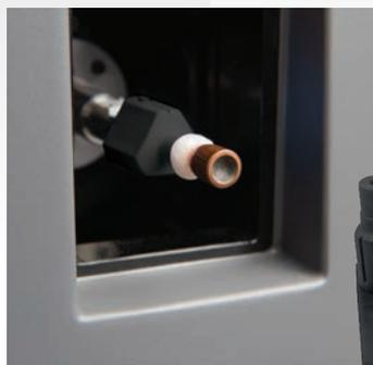
El portamuestras se fija magnéticamente al eje y se retrae automáticamente
