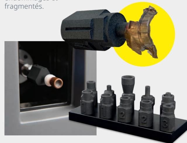
L'embout est fixé magnétiquement à l'arbre et se rétracte automatiquement
