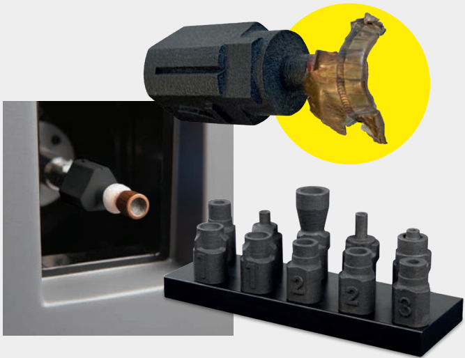
El portamuestras se fija magnéticamente al eje y se retrae automáticamente
