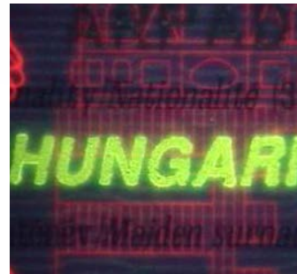
ARRIBA: PASAPORTE CON TINTAS ANTI-STOKE IZQUIERDA: PASAPORTE BAJO UVB 313NM DERECHA: FILIGRANA VISIBLE EN LUZ TRANSMITIDA
